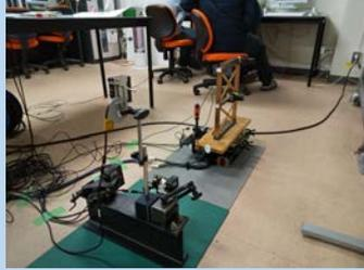
写真1 小型振動台での振動実験
