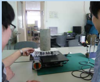
小型振動台での免震模型実験
