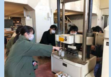
写真1 ゼミ生によるモルタル曲げ試験の様子
