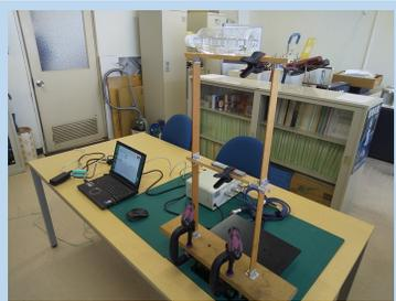
小型振動台と振動模型
